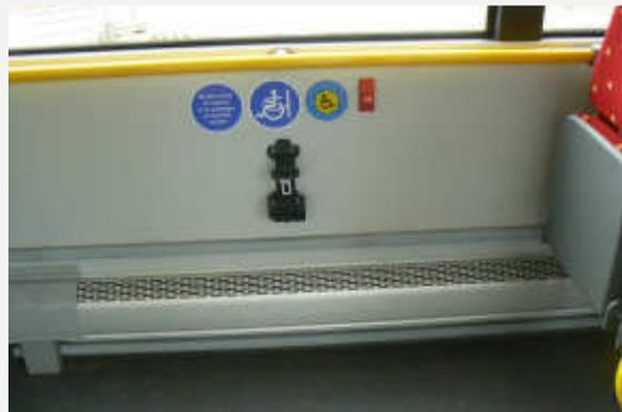
*Tout est prévu pour l'accueil des handicapés : agenouillement du bus, rampe repliable (manuelle !), emplacement sécurisé et signalé, bouton de demande d'arrêt (stop) et de manœuvre de la rampe. On apprécie l'accès par la porte centrale pour les PMR ambulants.*
